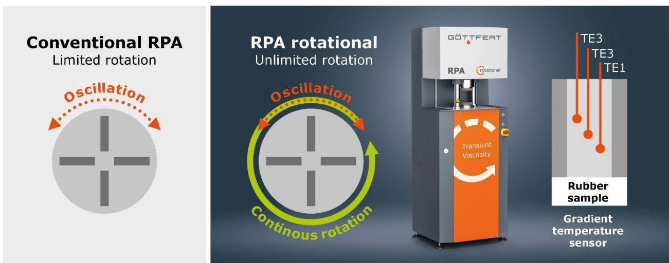
Abbildung 1: Herkömmliche Rubber Process Analyzer (RPA) sind Rotationsrheometer mit begrenztem Drehwinkel (links). Entsprechend sind die Messungen überwiegend auf oszillatorische Anregungen beschränkt. Der RPA rotational (rechts) gehört zu den ersten RPAs mit beweglicher Kammerhälfte, die Rotationen mit unbegrenzter Amplitude durchführen kann. Dadurch werden kontinuierliche Rotationsmessungen zur Bestimmung der stationären Scherviskosität möglich. Dank des integrierten Gradiententempersensors kann der Temperaturanstieg infolge dissipativer Erwärmung erfasst und korrigiert werden, sodass auch bei hohen Schergeschwindigkeiten zuverlässige Viskositätsdaten erhalten werden. Die Abbildung wurde einem Artikel der KGK Rubberpoint entnommen 1 .
